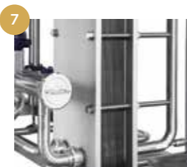
Cooling exchanger with prefilter on the machine. Échangeur de chaleur avec préfiltre sur la machine.
